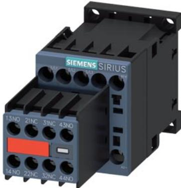
Contacteur de puissance, AC-3 12 A, 5,5 kW / 400 V 2 NO + 2 NF, 24 V CC 3 pôles, taille S00 borne à vis Interrupteur auxiliaire non amovible
