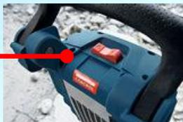
Interrupteur placé à l'avant pour éviter les arrêts non-intentionnels
