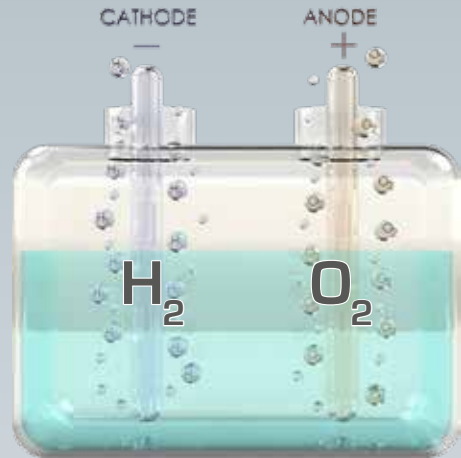
Electrolyse de l'eau
