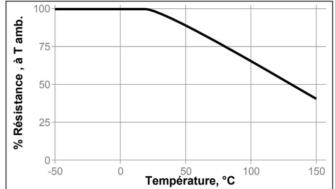
**Résistance au vieillissement à chaud**
