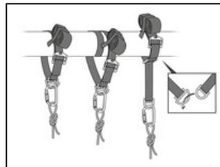
Elle offre plusieurs configurations pour installer un amarrage : directement sur un ancrage ou autour d'une structure adaptée.
