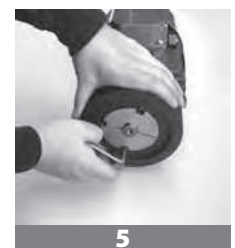
● Fori di smontaggio / Removal holes / Abdrückbohrungen / Trous d'extraction / Agujeros de desmontaje
