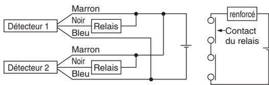
Branchement ET avec sortie NPN (avec détecteurs uniquement)
