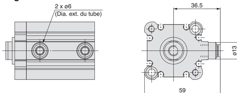
Note 2) Les dimensions de la course de Ø32-5 mm avec raccords instantanés intégrés sont identiques à celles du tube de vérin de course de 10 mm.
