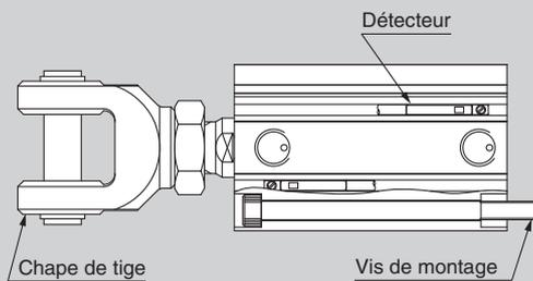
Fixation de montage **B** : Trou traversant (standard)
