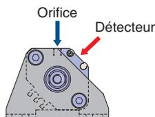
L'orifice et le détecteur sont côte à côte, permettant une manipulation facile.
