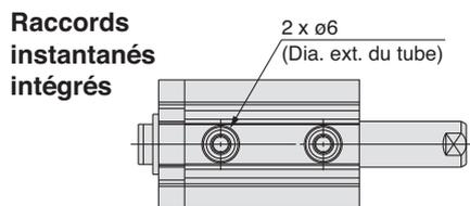
\* Les dimensions de la course de Ø32-5 mm avec raccords instantanés intégrés sont identiques à celles du tube de vérin de course de 10 mm. (mm)
