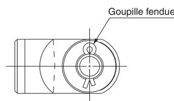
\* L'étrier est livré avec les goupilles fendues, l'axe d'articulation et les rondelles plates (non installés).
