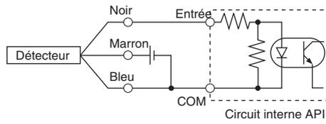
Connectez conformément aux spécifications d'entrée de l'API compatible, car la méthode de connexion varie en fonction des spécifications d'entrée de l'API.
