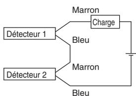
Si deux détecteurs sont branchés en série, un dysfonctionnement peut se produire car la tension de charge chute en position ON. La visualisation s'allume lorsque les deux détecteurs sont en position ON.
