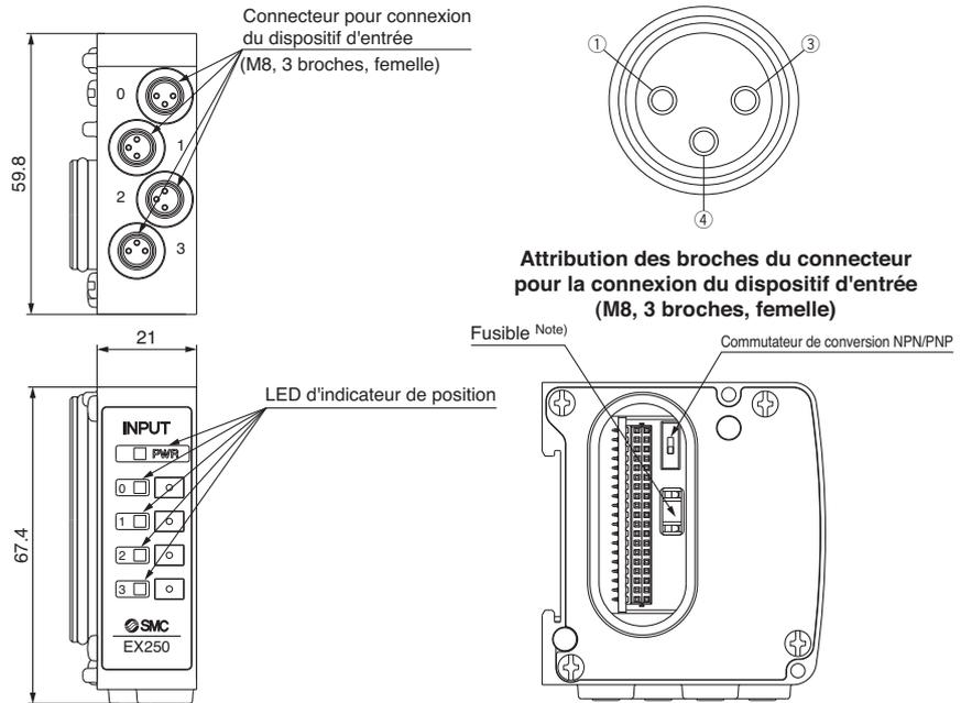
Note) Fusible pour protection de surintensité. Lorsque le fusible est grillé, après avoir traité la cause possible du problème, il peut être remplacé par un fusible comme indiqué dans les options page 19.
