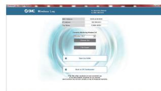
Les fichiers de connexion montrent le nombre d'entrées ou l'intensité des ondes radio reçues et peuvent être téléchargés sous forme d'un fichier csv.
