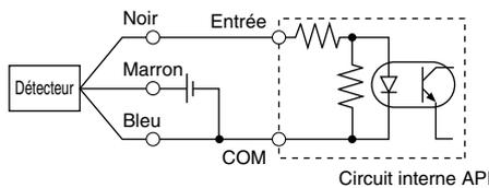
Connectez conformément aux spécifications d'entrée de l'API compatible, car la méthode de connexion varie en fonction de ces spécifications.
