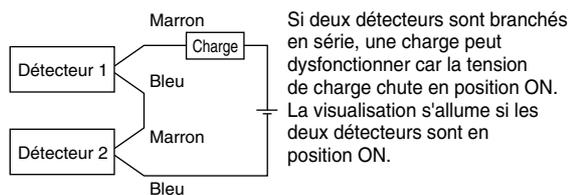
Si deux détecteurs sont branchés en série, une charge peut dysfonctionner car la tension de charge chute en position ON. La visualisation s'allume si les deux détecteurs sont en position ON.
