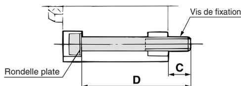
Note) Utilisez une rondelle plate pour fixer le vérin via les trous traversants.
