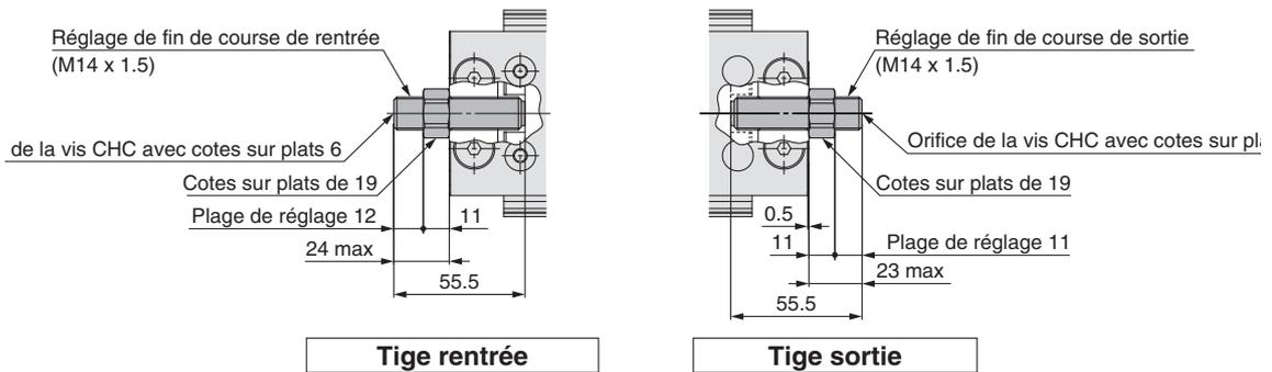
Amortisseur de chocs/RJ **ZG** : Deux extrémités, **ZH** : Tige sortie, **ZJ** : Tige rentrée, **ZQ** : Tige rentrée (Modèle à longueur totale réduite)
