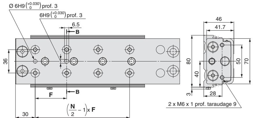
\*1 Les vis longues peuvent entrer en contact avec le bloc de guidage et entraîner un dysfonctionnement, etc. Utiliser une vis de longueur intermédiaire entre la profondeur de vissage et la profondeur de vissage minimale. Reportez-vous aux page 196 pour plus de détails.
