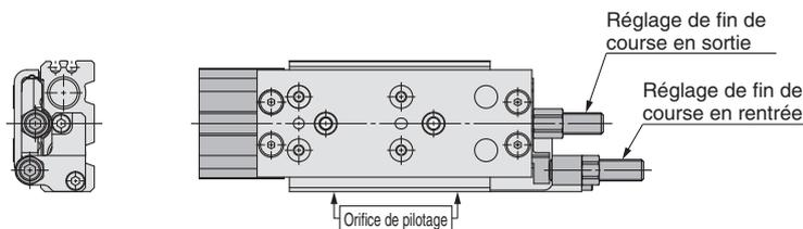
Modèle à raccord double
