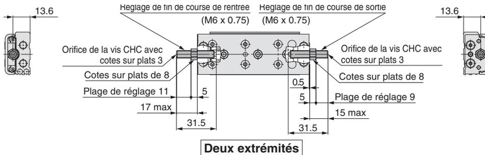
Amortisseur de chocs/RJ **ZG**: Deux extrémités, **ZH**: Tige sortie, **ZJ**: Tige rentrée, **ZQ**: Tige rentrée (Modèle à longueur totale réduite)
