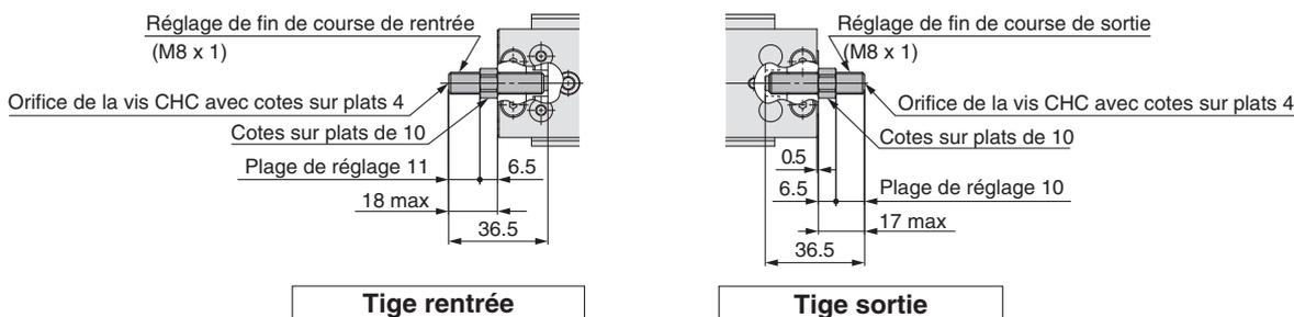
Amortisseur de chocs/RJ **ZG** : Deux extrémités, **ZH** : Tige sortie, **ZJ** : Tige rentrée, **ZQ** : Tige rentrée (Modèle à longueur totale réduite)
