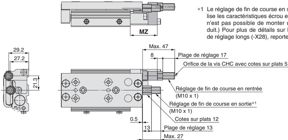
\*1 Le réglage de fin de course en sortie (amortisseur de chocs) utilise les caractéristiques écrou et vis de réglage longs (-X28). (Il n'est pas possible de monter un réglage standard sur le produit.) Pour plus de détails sur les caractéristiques écrou et vis de réglage longs (-X28), reportez-vous page 130.
