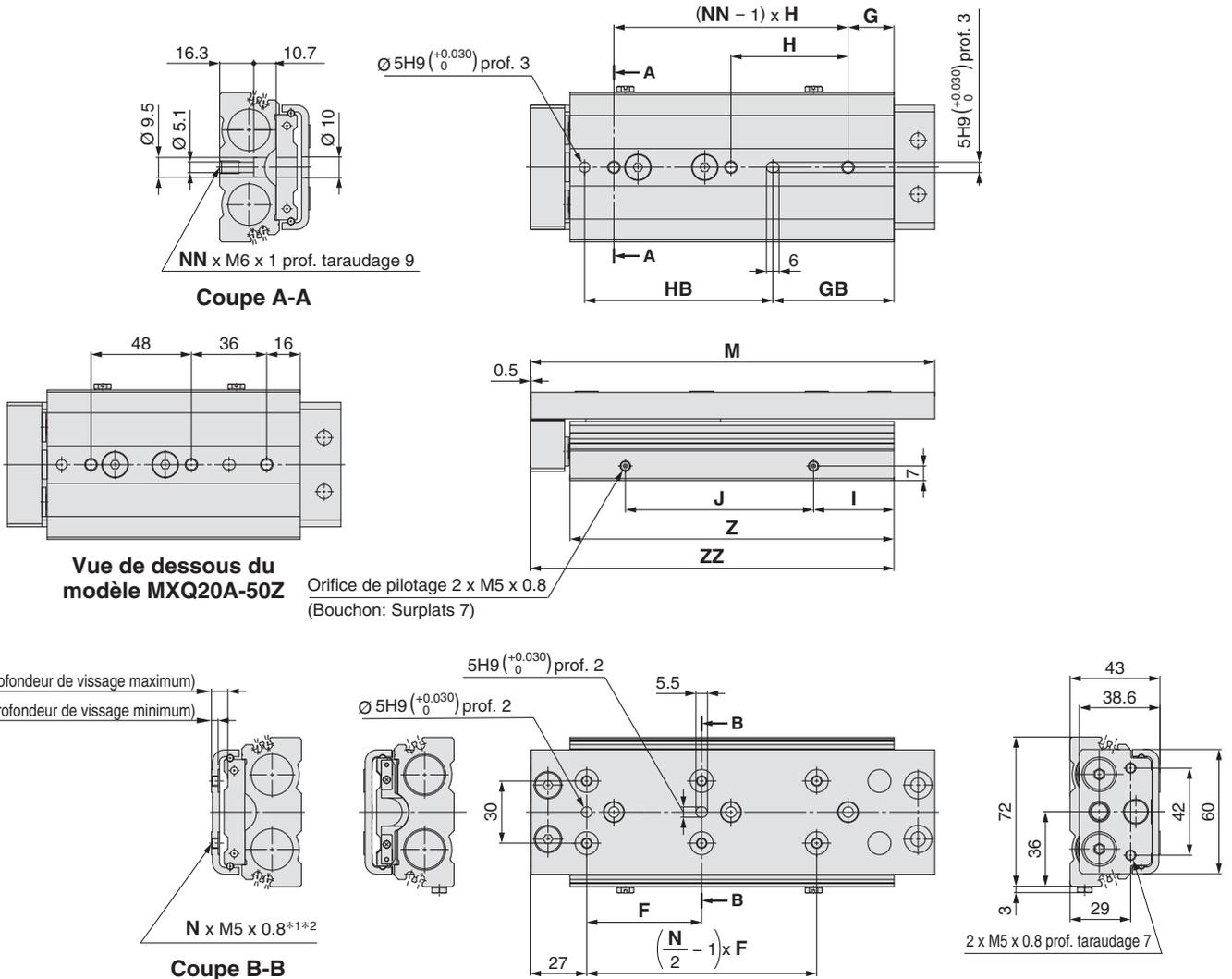
\*1 Les vis longues peuvent entrer en contact avec le bloc de guidage et entraîner un dysfonctionnement, etc. Utiliser une vis de longueur intermédiaire entre la profondeur de vissage et la profondeur de vissage minimale. Reportez-vous aux page 196 pour plus de détails.
