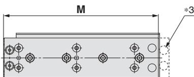
\*3 Puisque la longueur totale est réduite par le retrait des trous de montage du réglage de fin de course en sortie, il est impossible de monter un réglage de fin de course en sortie ultérieurement. (Le réglage de fin de course en rentrée peut se monter ultérieurement.)
