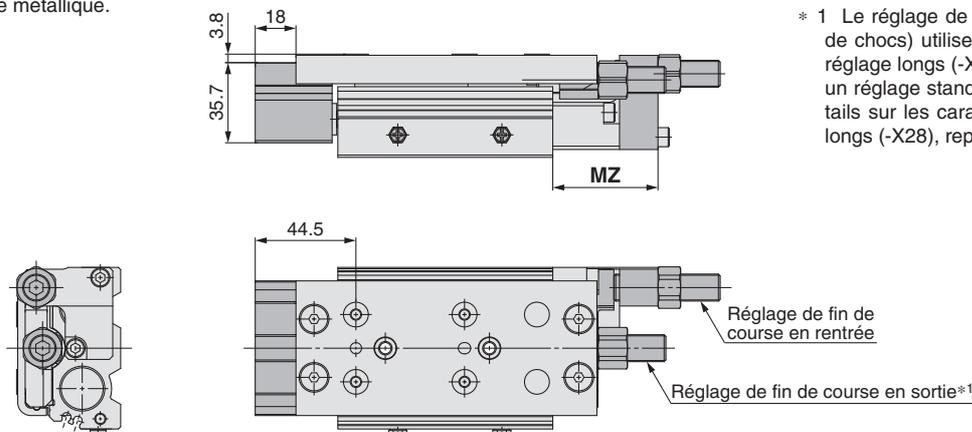
\* 1 Le réglage de fin de course en sortie (amortisseur de chocs) utilise les caractéristiques écrou et vis de réglage longs (-X28). (Il n'est pas possible de monter un réglage standard sur le produit.) Pour plus de détails sur les caractéristiques écrou et vis de réglage longs (-X28), reportez-vous page 130.
