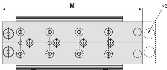
\*3 Puisque la longueur totale est réduite par le retrait des trous de montage du réglage de fin de course en sortie, il est impossible de monter un réglage de fin de course en sortie ultérieurement. (Le réglage de fin de course en rentrée peut se monter ultérieurement.)
