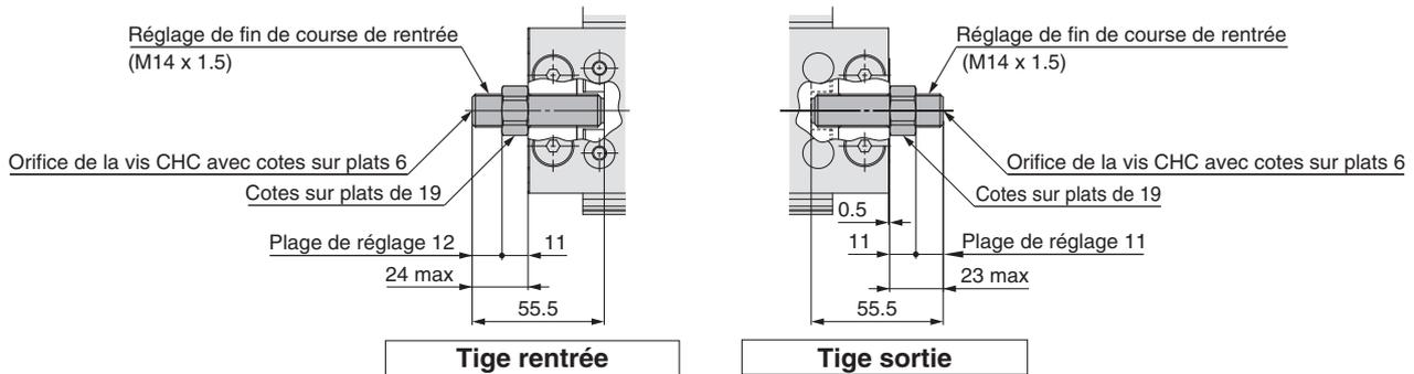
Amortisseur de chocs/RJ **ZG** : Deux extrémités, **ZH** : Tige sortie, **ZJ** : Tige rentrée, **ZQ** : Tige rentrée (Modèle à longueur totale réduite)
