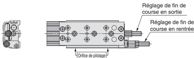
Modèle à raccord double
