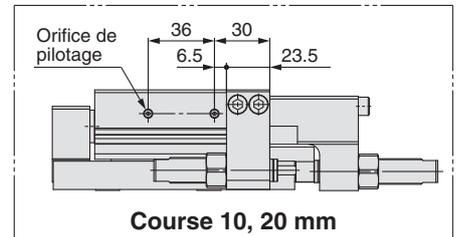
**MXQ25-□ZA-X2200(L): Butée métallique avec amortissement**
