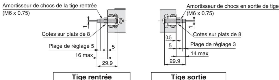
Butée métallique **ZK**: Deux extrémités, **ZL**: Tige sortie, **ZM**: Tige rentrée, **ZT**: Tige rentrée (Modèle à longueur totale réduite)
