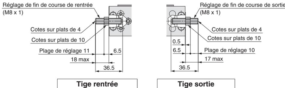
Amortisseur de chocs/RJ **ZG** : Deux extrémités, **ZH** : Tige sortie, **ZJ** : Tige rentrée, **ZQ** : Tige rentrée (Modèle à longueur totale réduite)
