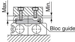
**⚠ Précaution** Pour éviter que les vis de montage de la pièce ne heurtent la table, utiliser des vis plus courtes d'au moins 0.5 mm que la profondeur maximale de vissage. \* 1 Des vis longues peuvent entrer en contact avec le bloc de guidage et provoquer des dysfonctionnements, etc.
