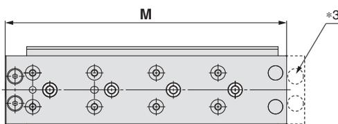
\*3 Puisque la longueur totale est réduite par le retrait des trous de montage du réglage de fin de course en sortie, il est impossible de monter un réglage de fin de course en sortie ultérieurement. (Le réglage de fin de course en rentrée peut se monter ultérieurement.)
