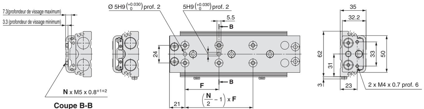
\*1 Les vis longues peuvent entrer en contact avec le bloc de guidage et entraîner un dysfonctionnement, etc. Utiliser une vis de longueur intermédiaire entre la profondeur de vissage et la profondeur de vissage minimale. Reportez-vous aux page 196 pour plus de détails.
