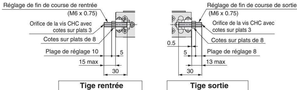
Butée métallique **ZK**: Deux extrémités, **ZL**: Tige sortie, **ZM**: Tige rentrée, **ZT**: Tige rentrée (Modèle à longueur totale réduite)
