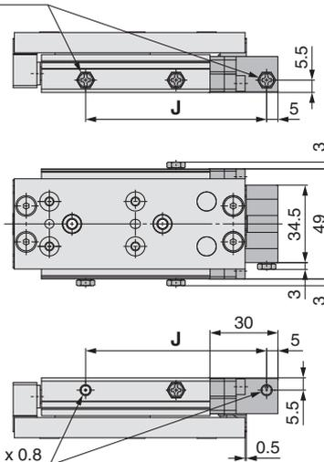
Orifice de pilotage 2 x M5 x 0.8
