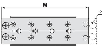
\*3 Puisque la longueur totale est réduite par le retrait des trous de montage du réglage de fin de course en sortie, il est impossible de monter un réglage de fin de course en sortie ultérieurement. (Le réglage de fin de course en rentrée peut se monter ultérieurement.)
