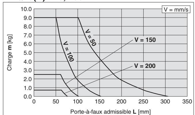
Déterminer le porte-à-faux. (Cf p.158 pour les détails.)
