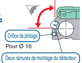
■ Les raccords et rainures de montage du détecteur sont prévus des deux côtés.
