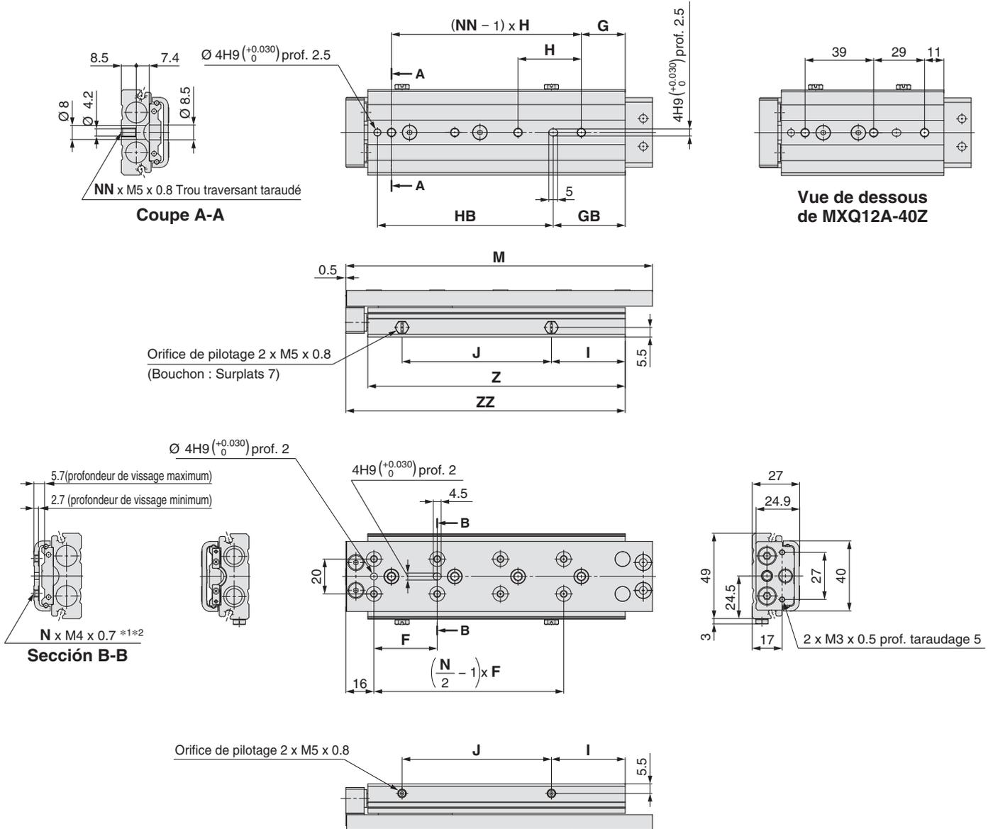
\*1 Les vis longues peuvent entrer en contact avec le bloc de guidage et entraîner un dysfonctionnement, etc. Utiliser une vis de longueur intermédiaire entre la profondeur de vissage et la profondeur de vissage minimale. Reportez-vous aux page 196 pour plus de détails.
