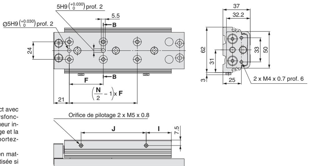
\*1 Les vis longues peuvent entrer en contact avec le bloc de guidage et entraîner un dysfonctionnement, etc. Utiliser une vis de longueur intermédiaire entre la profondeur de vissage et la profondeur de vissage minimale. Reportez-vous aux page 196 pour plus de détails.
