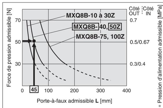
\* La pression d'alimentation admissible sur le côté OUT et sur le côté IN est la sortie théorique du vérin lorsqu'une force de pression est requise.
