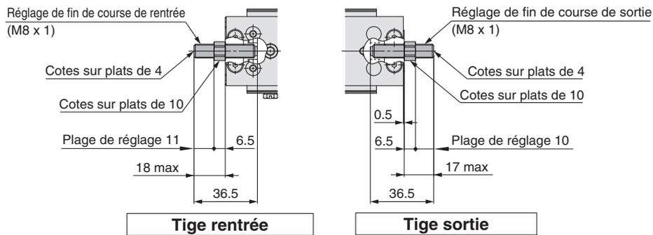
Amortisseur de chocs/RJ **ZG** : Deux extrémités, **ZH** : Tige sortie, **ZJ** : Tige rentrée, **ZQ** : Tige rentrée (Modèle à longueur totale réduite)
