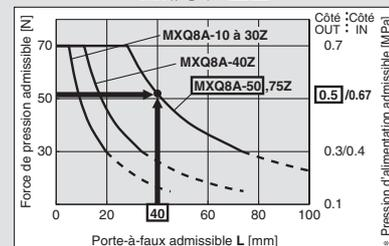
\* La pression d'alimentation admissible sur le côté OUT et sur le côté IN est la sortie théorique du vérin lorsqu'une force de pression est requise.
