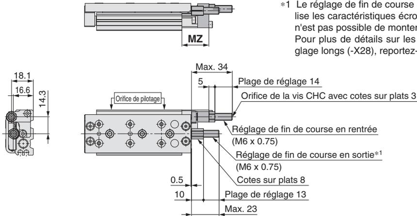
\*1 Le réglage de fin de course en sortie (amortisseur de chocs) utilise les caractéristiques écrou et vis de réglage longs (-X28). (Il n'est pas possible de monter un réglage standard sur le produit.) Pour plus de détails sur les caractéristiques écrou et vis de réglage longs (-X28), reportez-vous page 130.
