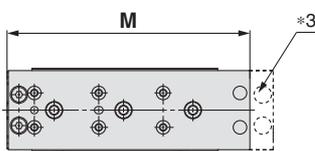
\*3 Puisque la longueur totale est réduite par le retrait des trous de montage du réglage de fin de course en sortie, il est impossible de monter un réglage de fin de course en sortie ultérieurement. (Le réglage de fin de course en rentrée peut se monter ultérieurement.)
