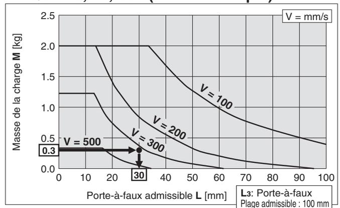
Modèle à raccord double
