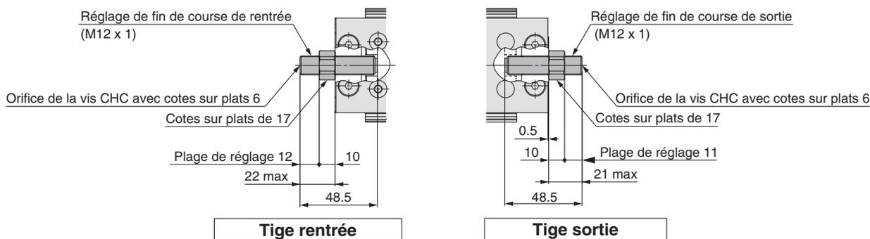
Amortisseur de chocs/RJ **ZG** : Deux extrémités, **ZH** : Tige sortie, **ZJ** : Tige rentrée, **ZQ** : Tige rentrée (Modèle à longueur totale réduite)
