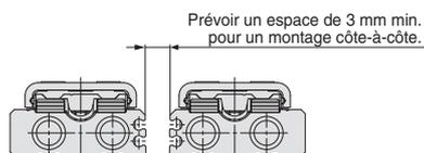
2. Veuillez noter qu'un détecteur avec un réglage centralisé à option fonctionnelle ne peut être installé dans certains endroits en raison du bloc de réglage. Suivez la méthode décrite ci-dessous. Dans le cas d'une course non marquée [x] dans le tableau ci-dessous, il est possible d'utiliser le détecteur après l'avoir inséré du côté plaque de fermeture.
