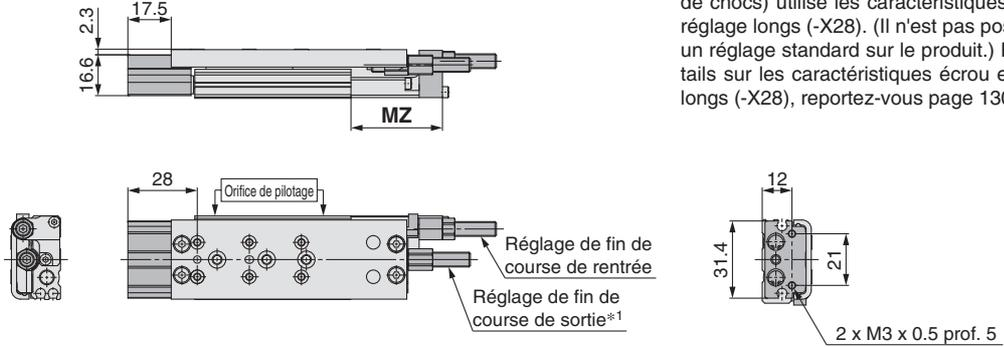
\* 1 Le réglage de fin de course en sortie (amortisseur de chocs) utilise les caractéristiques écrou et vis de réglage longs (-X28). (Il n'est pas possible de monter un réglage standard sur le produit.) Pour plus de détails sur les caractéristiques écrou et vis de réglage longs (-X28), reportez-vous page 130.
