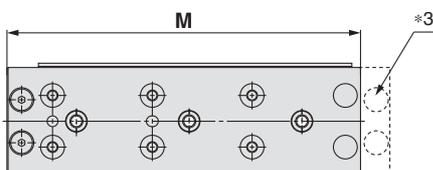
\*3 Puisque la longueur totale est réduite par le retrait des trous de montage du réglage de fin de course en sortie, il est impossible de monter un réglage de fin de course en sortie ultérieurement. (Le réglage de fin de course en rentrée peut se monter ultérieurement.)
