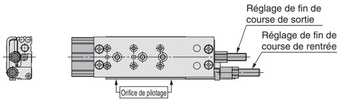
Modèle à raccord double
