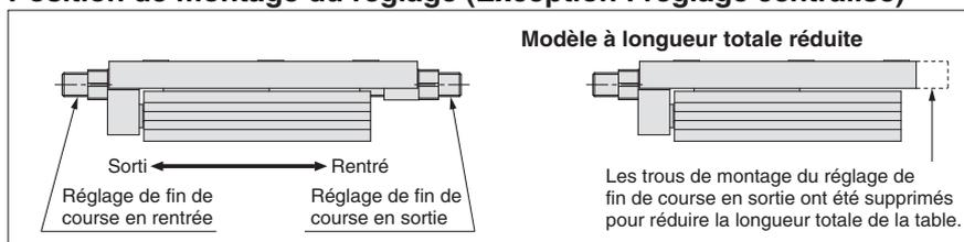
**Position de montage du réglage centralisé**
