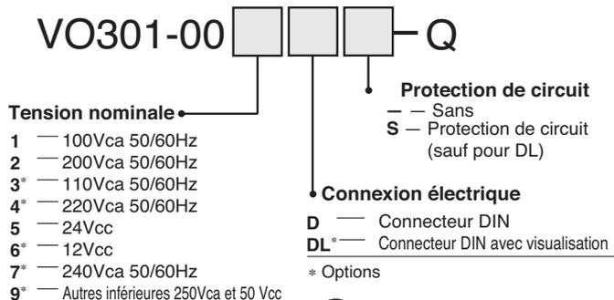
Note 1) Pour une connexion électrique de type D, les pièces du pilote sont les suivantes:
