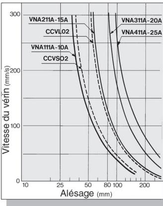
Cette série peut augmenter la capacité de distributeurs Air-Huile conventionnels. Idéale pour faire fonctionner des vérins à grand diamètre ainsi que pour utiliser simultanément plusieurs vérins et les arrêter. Ils peuvent, donc, être utilisés dans les mêmes applications que les échangeurs Air-Huile.
