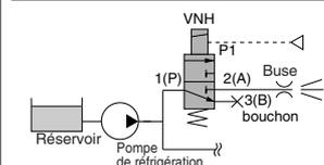
Application vanne 2/2 (Pas compatible avec le modèle à 7.0MPa)
