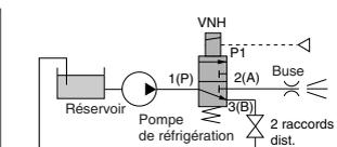
Pour réduire la charge de la pompe, le pr. réfrigérant passe de l'orifice B au réservoir sans arrêt.
