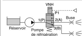
Buses d'actionnement sur produit de réfrigération.
