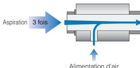
L'amplificateur d'air utilise l'effet Coanda, un phénomène grâce auquel un courant de jet adhère à une surface proche et s'y maintient lorsque les surfaces s'éloignent du sens du jet initial lorsqu'elles s'incurvent. En utilisant une petite quantité d'air comprimé comme source d'alimentation, les amplificateurs d'air aspirent de grands volumes d'air environnant pour produire en sortie un flux d'air de grand volume à haute vitesse.
