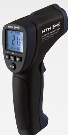
Établir un premier diagnostic du fonctionnement des machines grâce à une mesure précise de la température en toute sécurité à distance ou en contact.
