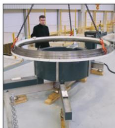
Ce dispositif spécial, développé pour une application éolienne, est capable de chauffer à 120°C en 60 minutes, des pièces pesant jusqu'à 10 tonnes d'un diamètre extérieur de 4 mètres.
