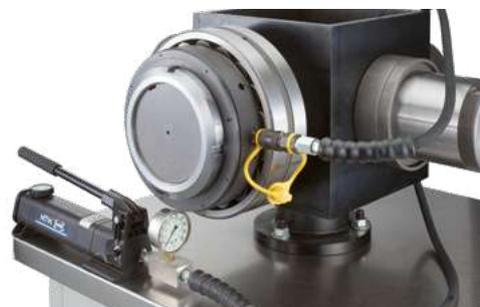
**Note :** On utilise le même écrou hydraulique pour le montage et le démontage.
