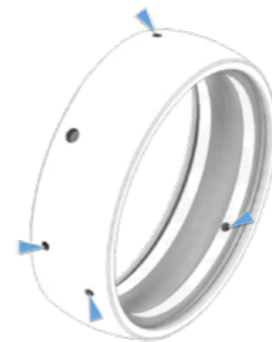
Système G2 : bague extérieure avec quatre orifices de lubrification sur deux plans
