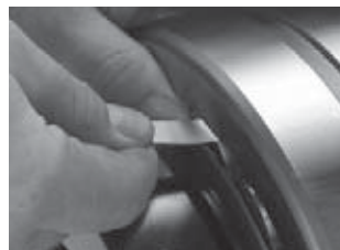
Fig. 14. Mesure du jeu radial interne avant l'installation.
