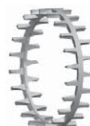
Fig. 8. Cage monobloc à cames ou ergots, usinée en laiton, guidée par la bague intérieure.
