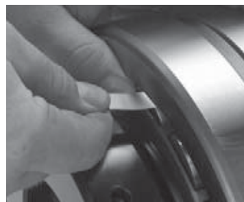
Fig. 18. Mesure du jeu radial interne avant l'installation.
