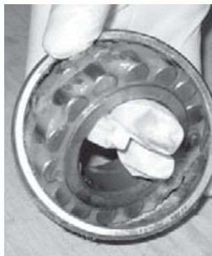
Fig. 21. La graisse peut être appliquée facilement à la main.
