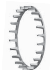
Fig. 9. Cage à ergots en deux parties, usinée en laiton, guidée par la bague intérieure.
