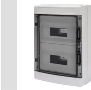
Gamme IP65 de coffrets étanches de 8 à 72 modules avec porte transparente fumée et équipés de borniers multipolaires de câblage à vis, 80 A, IP20.. Les principales caractéristiques techniques sont : façade et panneau arrière réversibles, cadres et plastrons ouverts amovibles et portes détachables avec ouverture jusqu'à 180 ° et accessoire de verrouillage.. Les borniers permettent de créer un câblage simple et net en réduisant le temps d'installation du coffret..
