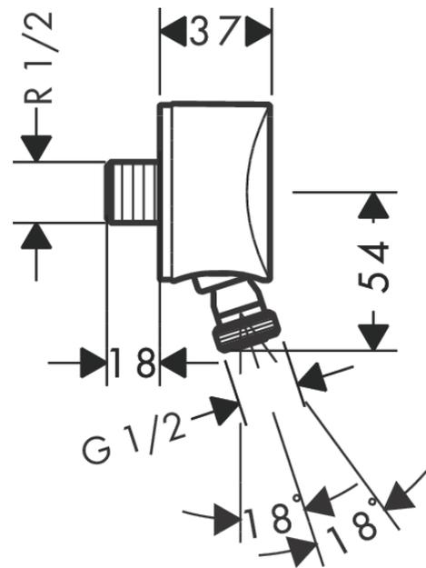
**FixFit****Coude de raccordement S sur rotule**Surfaces: **chromé** Numéro d'article: **27506000**
