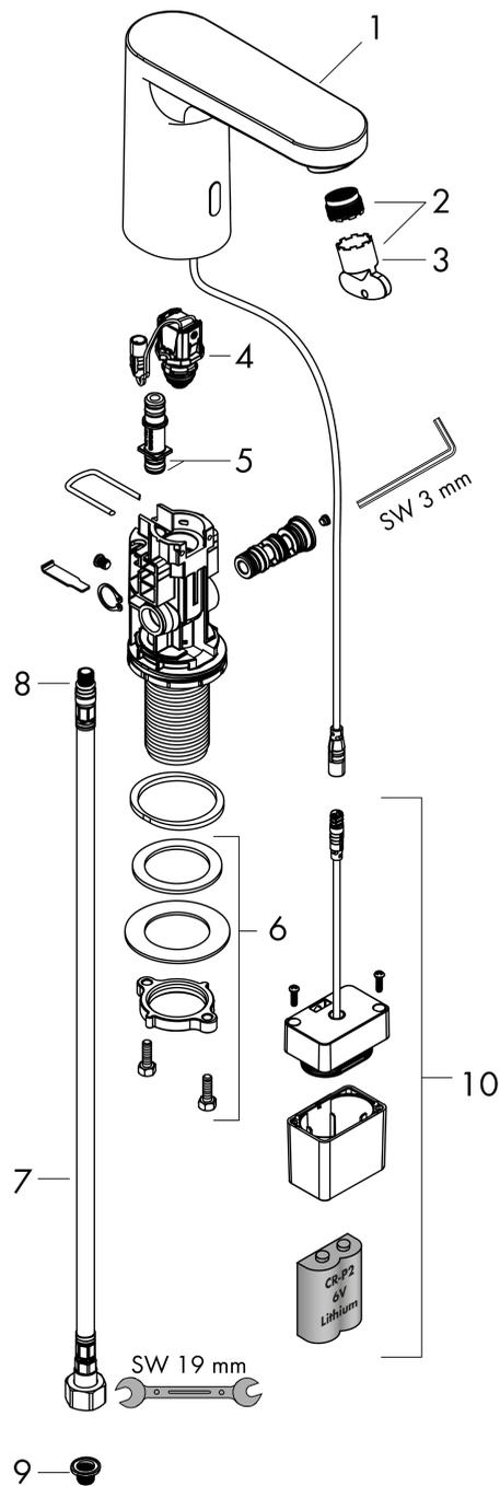
**Vernis Blend****Mitigeur de lavabo électronique avec pré-réglage de la température ou en eau froide sur batterie**Surfaces: **chromé** Numéro d'article: **71503000**
