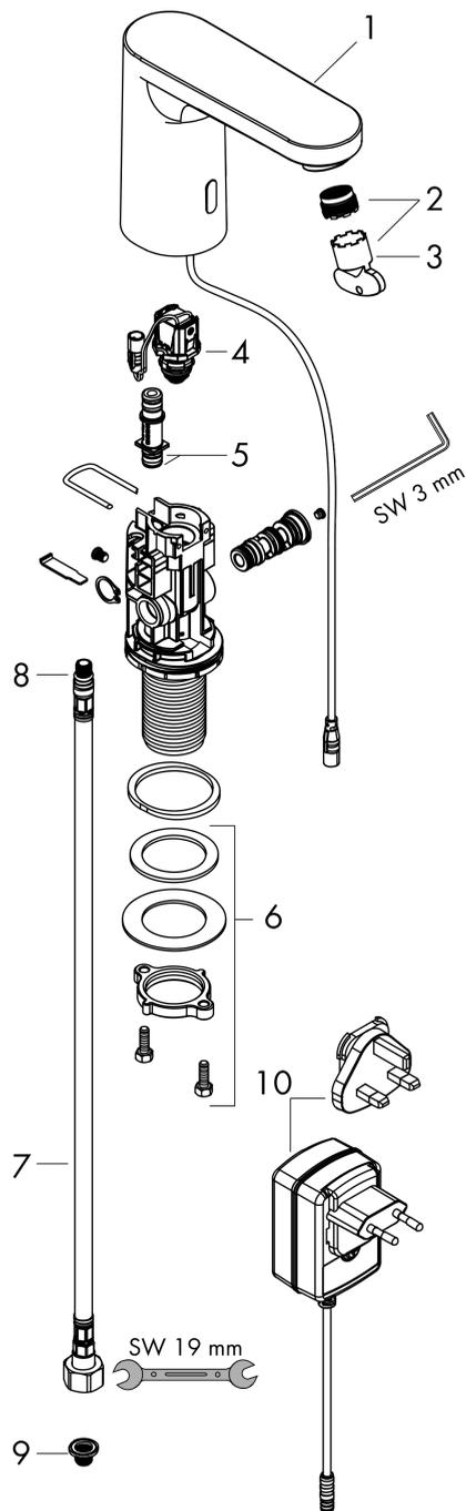
**Vernis Blend****Mitigeur de lavabo électronique avec pré-réglage de la température ou en eau froide sur secteur**Surfaces: **chromé** Numéro d'article: **71504000**
