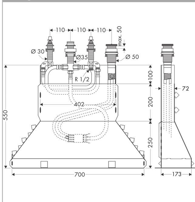
**Corps d'encastrement pour combiné mélangeur 4 trous pour montage sur bord de baignoire**
