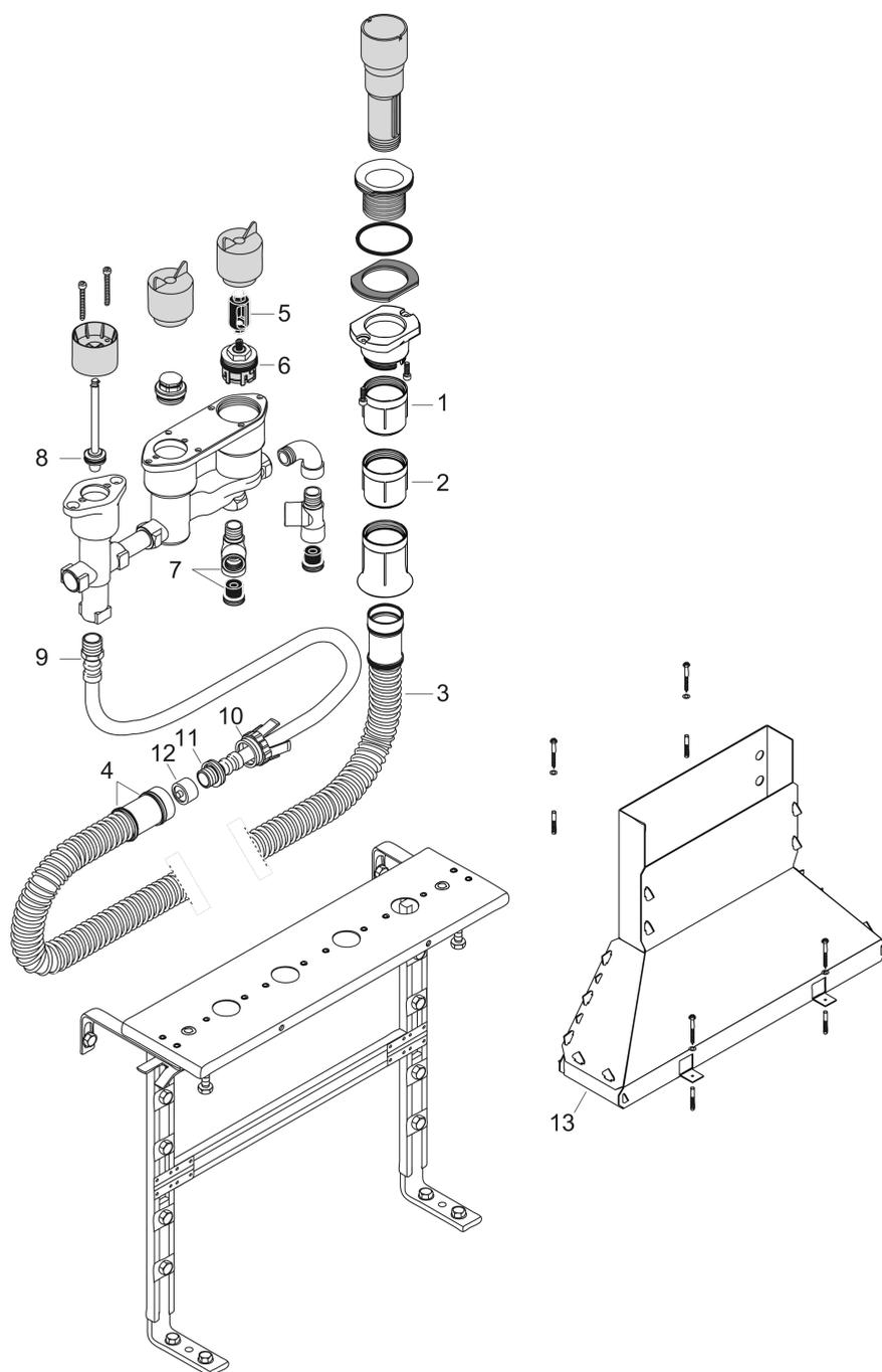
**Corps d'encastrement pour combiné 4 trous pour batterie 4 trous thermostatique pour montage sur plage de carrelage**
