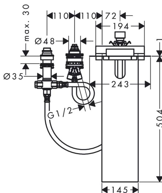
**Corps d'encastrement pour combiné mitigeur 3 trous pour montage sur bord de baignoire**
