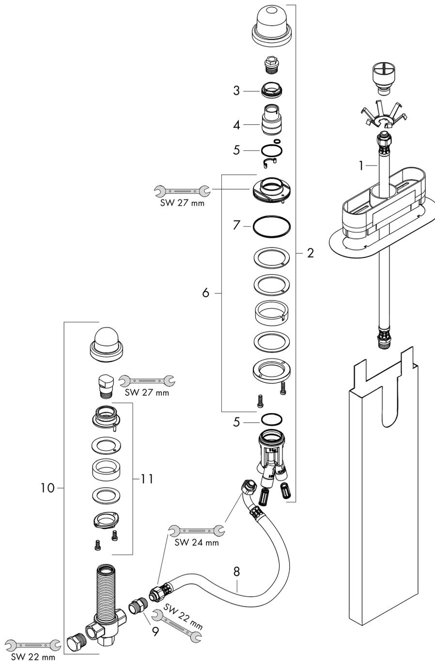
**Corps d'encastrement pour combiné mitigeur 3 trous pour montage sur bord de baignoire**
