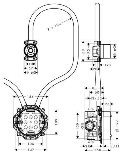
**Corps d'encastement pour mitigeur électronique encastré**
