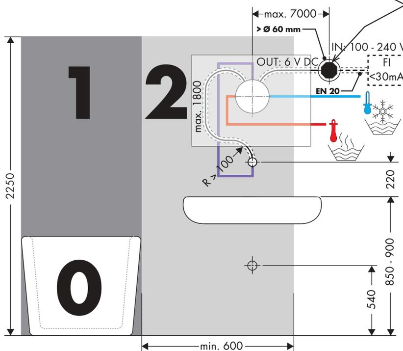
**Corps d'encastrement pour mitigeur électronique encastré**
