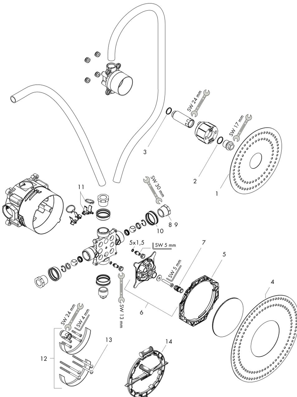
**Corps d'encastrement pour mitigeur électronique encastré**
