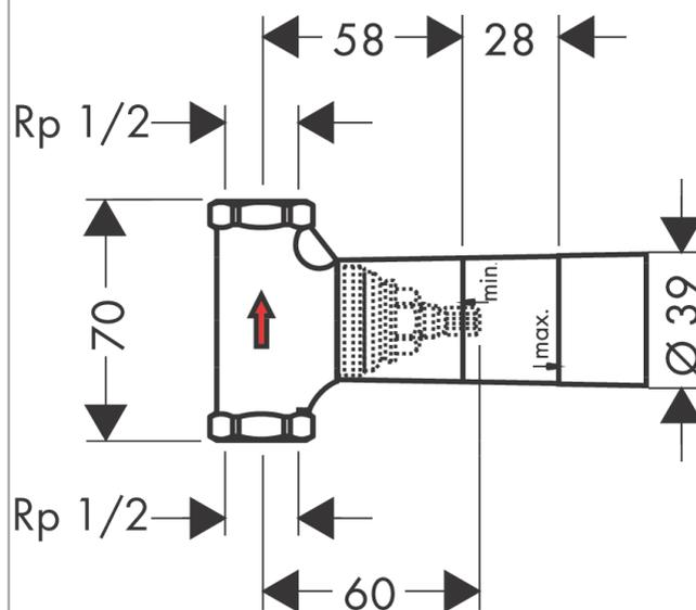
**Corps d'encastrement 1/2" à clapet**
