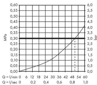
**Corps d'encastrement 1/2" à clapet**
