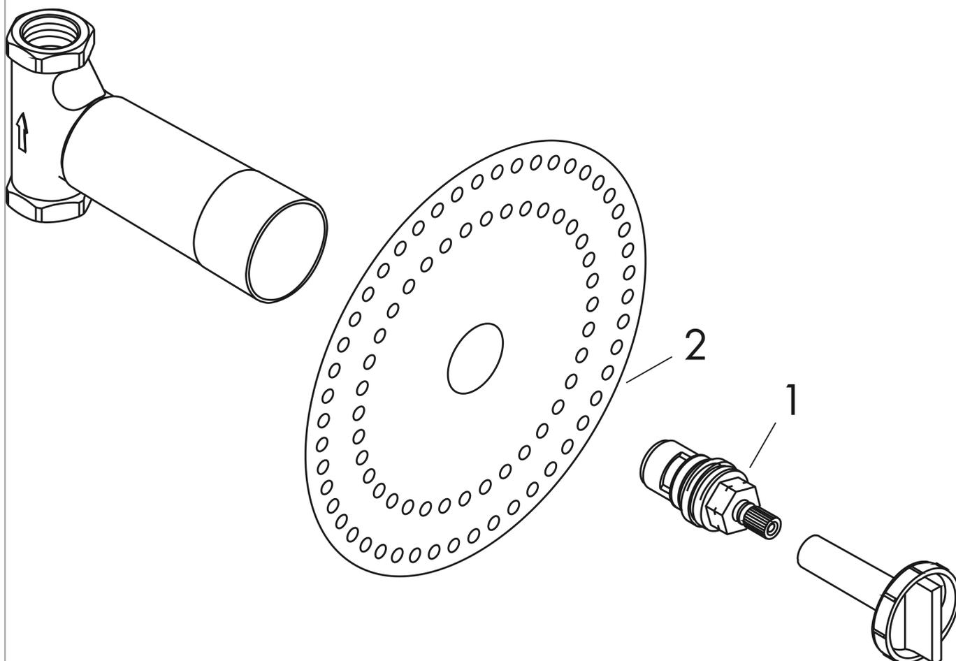
**Corps d'encastrement 1/2" à clapet**
