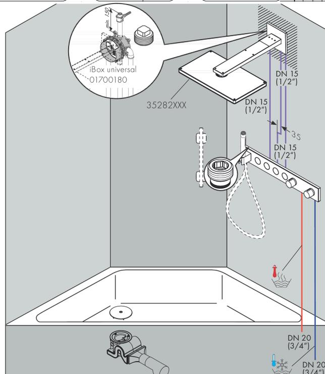
**Corps d'encastrement pour module thermostatique 4 fonctions**
