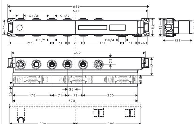
**Corps d'encastrement pour module thermostatique 4 fonctions**
