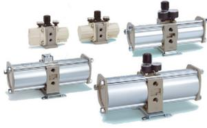
Augmente la pression du circuit principal jusqu'à une valeur réglable. Economie d'énergie plus importante. Pas d'autres sources énergétiques requises. Température d'utilisation de 2 à 50° C. Pression d'entrée de 0.1 à 1 MPa. Montage horizontal.
