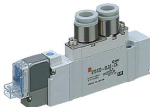
Electrodistributeur pour vérins unitaires. Durée de vie d'au moins 50 millions de cycles. Faible consommation électrique : 0.35 W à 24 Vcc. Temps de réponse : 10 ms. Montage facile et rapide grâce aux raccords instantanés prémontés.
