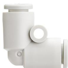
Union double égal et inégal coudé à 90° série KQ2L. Raccords instantanés pour tube Polyamide ou Polyuréthane. Ø de tube de 4 à 12mm. Pression de service : 10 bar. Corps en PBT.
