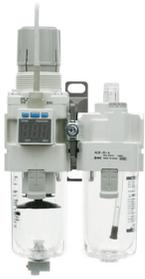
Montage modulaire ou unitaire. Orifice de 1/8 à 3/4. Protection de cuve transparente à partir de la taille 30 en standard. Filtre avec purge manuelle ou automatique en option. Débit supérieur à l'ancienne version. Plage de température de -5 à 60°C.
