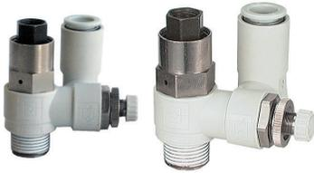
Limiteurs de débit avec un clapet piloté intégré. Cette combinaison permet ainsi de contrôler la vitesse du vérin et d'effectuer temporairement des arrêts intermédiaires. Cette série offre une liberté de montage du tube de 360 degrés.
