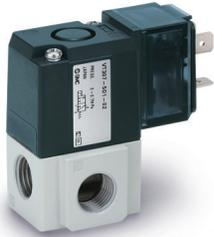
Distributeur 3/2 (également 2/2) en standard, fonctions NF, NO. Orifice G 1/8", G 1/4". Version sur embase, version pour le vide en option. Connecteur IP65, avec visualisation et protection de circuit. Tension CC ou CA.
