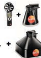
Idéalement adapté pour la mesure du débit volumétrique sur les sorties de ventilation grâce à ses cônes enfichables.
