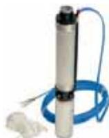
Pour liquide pompé : propre, sans corps solides ou abrasifs, non agressif, non visqueux, non cristallin et chimiquement neutre. Température du liquide pompé : de 0 °C à + 30 °C. Hydraulique avec turbines radiales flottantes.
