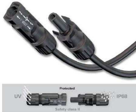
Pour raccorder les modules, des câbles solaires spéciaux d'un diamètre minimum de 4 mm<sup>2</sup> ainsi que les connecteurs appropriés doivent être utilisés. Ces câbles doivent être résistants aux UV et à l'usure. Éviter de laisser les câbles exposés aux éléments ou les placer dans une gaine protectrice.
