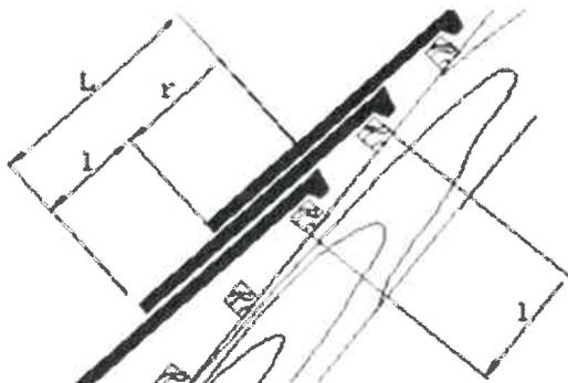
**Exemple d'incompatibilité : on voit bien sur le présent schéma qu'il n'est pas envisageable de fixer le crochet**
