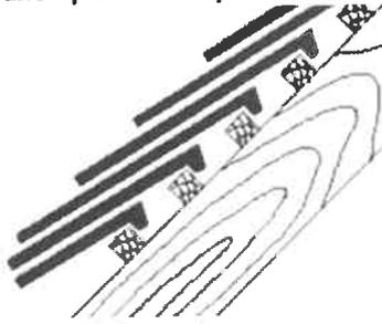
❖ **AVEC LES CROCHETS DESTINES AUX COUVERTURES EN TUILES EN BETON à emboîtement à pureau plat – (Crochets SingleHook 2)**
