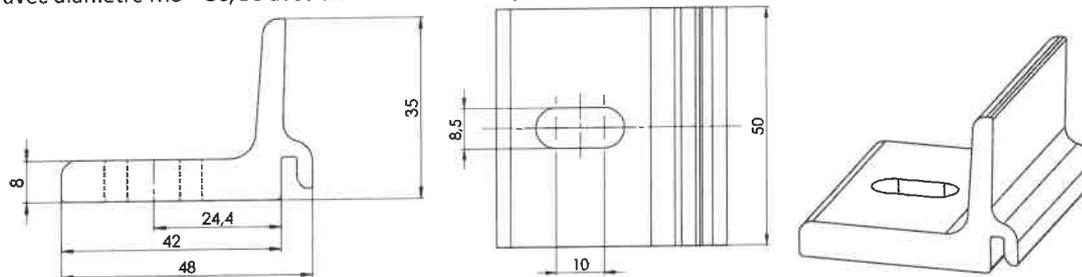
**La nouvelle version :** laquelle est subdivisée en plusieurs versions de Climbers selon le diamètre de la vis (36/50 RoofHook avec diamètre M8 – 36/50 avec diamètre M10 et 36/50 avec diamètre M12)
