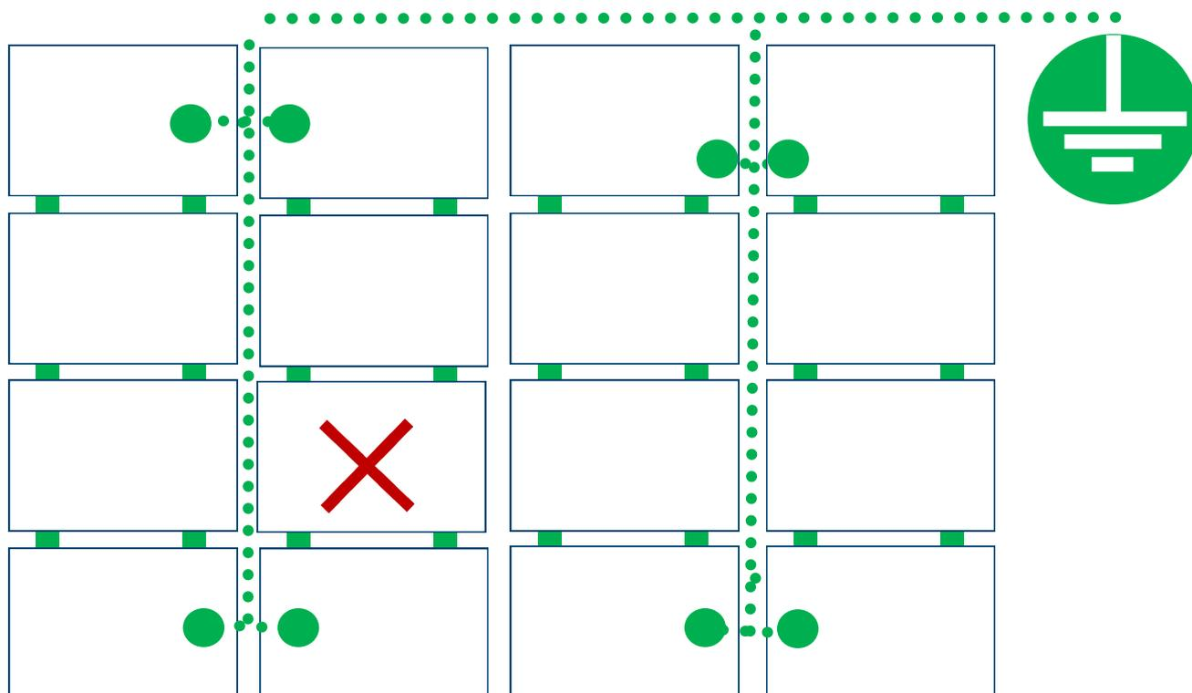
Les connexions à la terre entre les modules sont effectuées de façon mécanique grâce à la bride centrale JORISOLAR ST02 équipé de la Terragrif PL.
