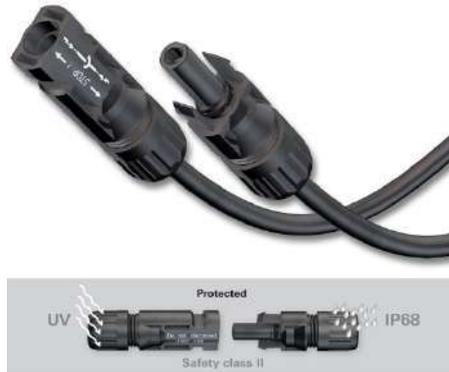
Pour raccorder les modules, des câbles solaires spéciaux d'un diamètre minimum de 4 mm<sup>2</sup> ainsi que les connecteurs appropriés doivent être utilisés. Ces câbles doivent être résistants aux UV et à l'usure. Eviter de laisser les câbles exposés aux éléments ou les placer dans une gaine protectrice.
