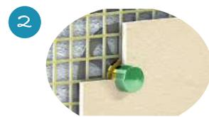
2 Habiller la grille support d'un treillis plastique. Positionner le bouchon de protection en fonction de l'épaisseur d'enduit prévue. Projeter l'enduit de façade.
