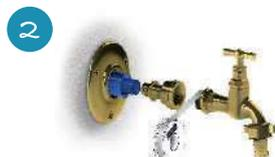
2 Sortir le tube PER et sa gaine à l'avant de l'applique. Visser le robinet sur l'embout PER, joindre à l'aide de téflon® ou de résine anaérobie. (Filasse proscrite).
