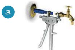
3 Raccorder le robinet au tube PER selon le type de raccord choisi. (Exemple d'un raccord à glissement).
