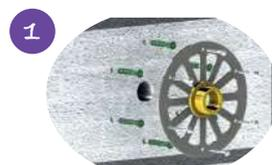
1 Percer un trou (Ø environ 30mm), Positionner la grille support au centre du perçage (vis pointeau de blocage dirigée vers le bas). Percer et loger les chevilles (Ø 8mm). Fixer la grille.
