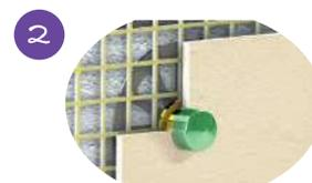
2 Habiller la grille support d'un treillis plastique. Positionner le bouchon de protection en fonction de l'épaisseur d'enduit prévue. Projeter l'enduit de façade.
