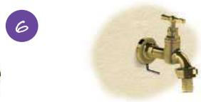
6 Positionner le robinet à la verticale. Bloquer la vis sans forcer. (clé 6 pans fournie).
