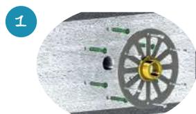
1 Percer un trou (Ø environ 30mm), Positionner la grille support au centre du perçage (vis pointeau de blocage dirigée vers le bas). Percer et loger les chevilles (Ø 8mm). Fixer la grille.
