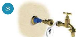
3 Sortir le tube PER et sa gaine au travers de la grille. Visser, joindre la liaison du robinet à l'aide de téflon® ou de résine anaérobie. (Filasse proscrite).
