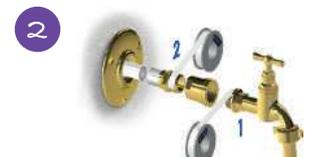
2 Visser et joindre le robinet sur l'embout à l'aide de téflon® ou de résine anaérobie. (Filasse proscrite). Visser et joindre le raccord à sertir (U - H - TH) sur l'embout.
