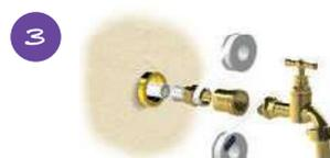
3 Visser et joindre le robinet sur l'embout à l'aide de téflon® ou de résine anaérobie (filasse proscrite). Visser et joindre le raccord sur l'embout.
