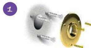
1 Percer un trou (Ø environ 30mm), Positionner l'applique (vis pointeau de blocage dirigée vers le bas). Percer et loger les chevilles (Ø 6mm). Fixer l'applique.
