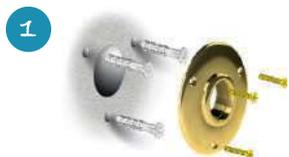
1 Percer un trou (Ø environ 30mm), Positionner l'applique (vis pointeau de blocage dirigée vers le bas). Percer et loger les chevilles (Ø 6mm). Fixer l'applique.
