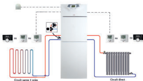
Odia HTE avec 1 circuit direct + 1 circuit vanne 3 voies avec boîtier de régulation sur chaudière
