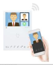
La fonction de reconnaissance faciale implémentée sur le moniteur SBC Mini avec WiFi art.6741W permet d'ouvrir automatiquement la porte de la maison ou la porte de la copropriété (connectée à la sortie de la platine de rue ou à la sortie de l'actionneur art.1256) sans utiliser les clés, l'application, le lecteur, les clés électroniques, le clavier codés, mais seulement avec votre propre visage.
