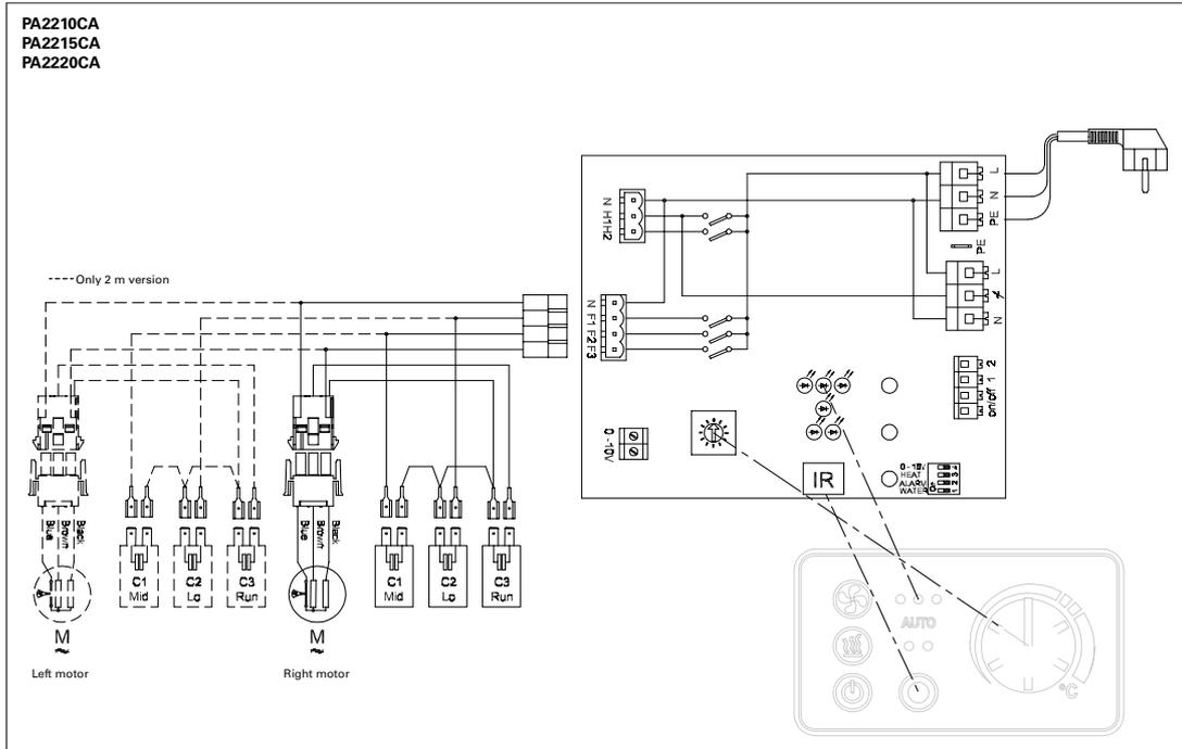
Appareil avec chauffage électrique
