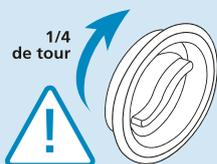
Positionner un bouchon dans les piquages non raccordés
