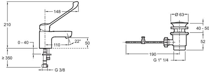
Descriptif CCTP : Mitigeur lavabo avec levier long Easy. E16024-4. Collection : EASY. POIDS : 1,2 kg. NORMES ET RÉGLEMENTATIONS : ACS : 14 ACC LY 511. TYPE : Mitigeur. DÉBIT (L/MN SOUS 3 BARS) : 13 l/mn. HAUTEUR TOTALE DU ROBINET (MM) : 210. SAILLIE DU BEC (MM) : 110. RACCORDS : Avec flexibles d'alimentation. MÉCANISME : Cartouche séquentielle. TYPE D'INSTALLATION : 1 trou. GARANTIE MÉCANISME : 5 ans. Levier à commande au coude de 150 mm monté en usine. Bonde de vidage.
