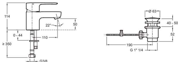
Descriptif CCTP : Mitigeur lavabo avec flexibles d'alimentation PEX. E16027-4D. Collection : JULY. POIDS : 1,5 kg. NORMES ET RÉGLEMENTATIONS : NF : I - ECAU : E0 C2 A2 U3 (Ge3) - ACS : 10 ACCLY 113. TYPE : Mitigeur. DÉBIT (L/MN SOUS 3 BARS) : 10 l/mn. MÉCANISME : Cartouche à disques céramique. ECO CONSO : ECO D'EAU. VIDAGE : Avec vidage. MITIGEUR DE BAIN : MITIGEUR. TYPE D'INSTALLATION : 1 trou. GARANTIE MÉCANISME : 5 ans. Bonde de vidage en métal.
