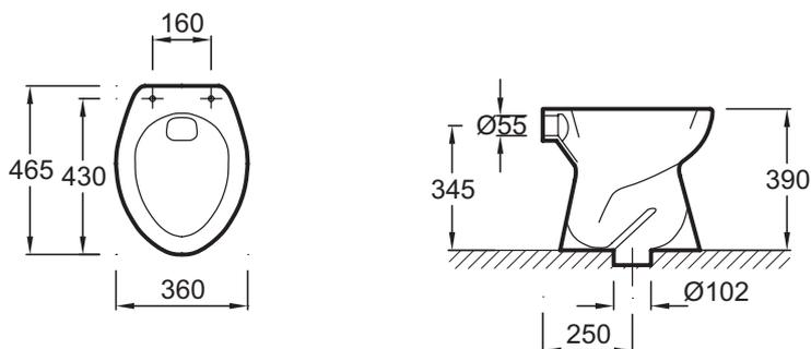
Descriptif CCTP : Cuvette indépendante, sortie centrale verticale cachée. E1639. Collection : COLLECTIVITÉ. DIMENSIONS : 46,50 x 36 cm. POIDS : 14,6 kg. MATÉRIAU : Céramique. TYPE D'INSTALLATION : Au sol. CONSOMMATION D'EAU : Standard 3/6 L. HAUTEUR : Standard. TYPE DE BRIDE : Ouverte (traditionnelle). Fonctionnement 6 L. Sortie verticale.
