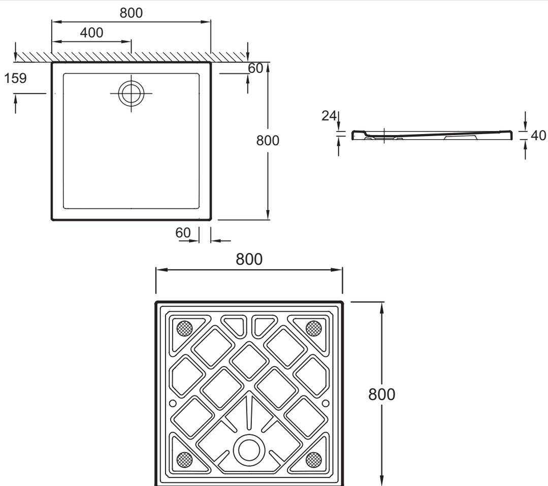
Descriptif CCTP : Receveur extra plat à poser ou à encastrer 80x80 cm. ENB90. Collection : KYREO. DIMENSIONS : 80 x 80 x 4 cm. POIDS : 24,3 kg. MATÉRIAU : Céramique. TYPE D'INSTALLATION : Posé ou encastré. NORMES ET RÉGLEMENTATIONS : NF. FORME : Carré. DIAMÈTRE DE BONDE (CM) : 90 mm. MOTIF DE SURFACE : Lisse. NIVEAU D'ADHÉRENCE : Pn6. LIVRÉ AVEC BONDE : Non.
