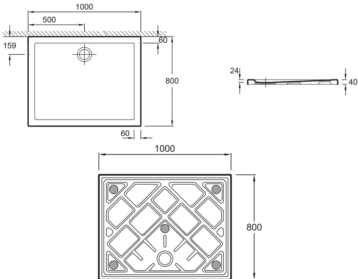
Descriptif CCTP : Receveur extra plat 100 x 80 cm. ENF90. Collection : KYREO. DIMENSIONS : 100 x 80 x 4 cm. POIDS : 29,9 kg. MATÉRIAU : Céramique. TYPE D'INSTALLATION : Posé ou encastré. NORMES ET RÉGLEMENTATIONS : NF. FORME : Rectangulaire. DIAMÈTRE DE BONDE (CM) : 90 mm. MOTIF DE SURFACE : Lisse. NIVEAU D'ADHÉRENCE : PN6. LIVRÉ AVEC BONDE : Non.
