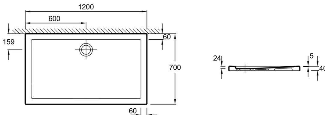
Descriptif CCTP : Receveur extra-plat 120 x 70 cm. EN090. Collection : KYRÉO. DIMENSIONS : 120 x 70 x 4 cm. POIDS : 32,4 kg. MATÉRIAU : Céramique. TYPED'INSTALLATION : Posé ou encastré. ANTIDÉRAPANT : Non. FORME : Rectangulaire. DIAMÈTRE DE BONDE (CM) : 9. MOTIF DE SURFACE : Lisse. NIVEAU D'ADHÉRENCE : PN6. LIVRÉ AVEC BONDE : Non. DURÉE GARANTIE (ANNÉES) : 10.
