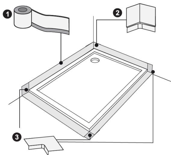
(1) Bande d'étanchéité (2) Angle entrant (3) Angle multifonction
