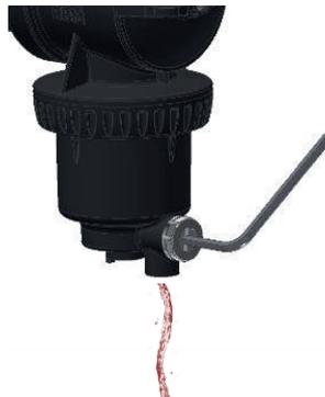
Ouvrir l'évacuation. La saleté à l'intérieur du filtre qui n'est plus attirée par l'aimant sera entraînée à l'extérieur par le flux d'eau qui s'écoule. Utiliser un récipient de collecte d'une capacité d'au moins 0,5 l.
