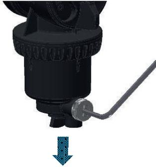
Ouvrir la vanne de vidange. Pour dépressuriser l'installation (5 secondes) et refermer. Positionner un récipient pour collecter l'eau de vidange.
