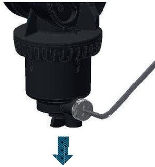
Ouvrir la vanne de vidange pour éliminer la pression de l'installation (5 secondes) et refermer. Positionner un récipient pour collecter l'eau de vidange.
