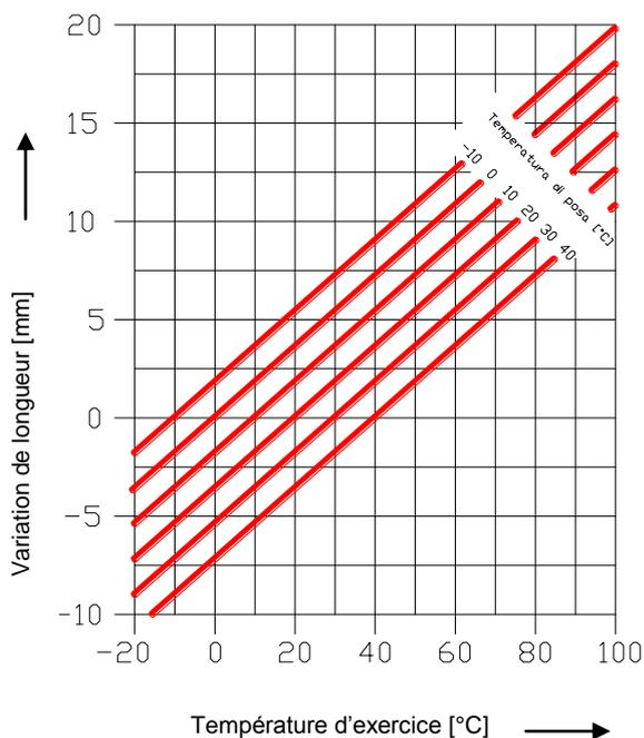
Le diagramme ci-contre suppose une dilatation linéaire de 1 m de tube (mesuré à la température de pose  $T_{\text{posa}}$ ), dès sa mise en service.
