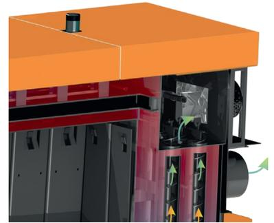
**La facilité du chargement bois :** « Le Tunnel d'échappement » en partie supérieure aspire automatiquement les gaz de combustion en cas de chargement. Dès que vous ouvrez la porte de chargement, l'extracteur déclenche sa vitesse supérieure aspirant les fumées en suspension dans le foyer et vous permet de faire le chargement sans aucune gêne.
