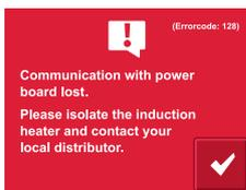
Les erreurs fatales ne peuvent être résolues sans contacter le distributeur local, puisque le problème est causé par une erreur matérielle ou logicielle interne. Lors d'une erreur fatale, l'utilisateur doit noter le code d'erreur (indiqué dans le coin supérieur droit) et les conditions de fonctionnement. Les conditions de fonctionnement peuvent inclure une description de la pièce ayant été chauffée, le mode de chauffe utilisé, ainsi que toute autre information pertinente.
